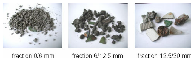
Figure 1. Différentes fractions granulaires du mâchefer étudié
