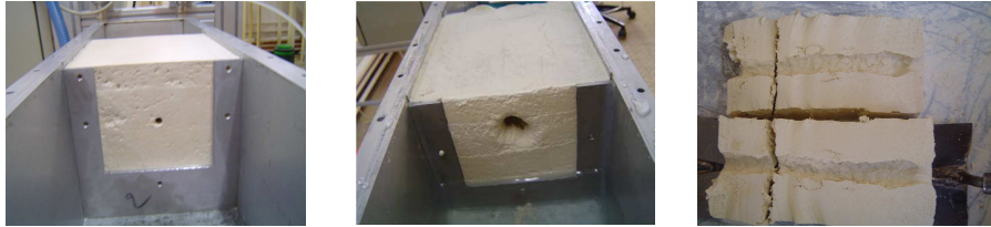
Figure 7. Exemple d'agrandissement du trou durant l'essai d'érosion.
