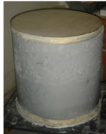
Figure 6 : Structure isolée et à 30°C (0 à 20h) Figure 7 : Structure décoffrée et à 5°C (20h à 7j)
