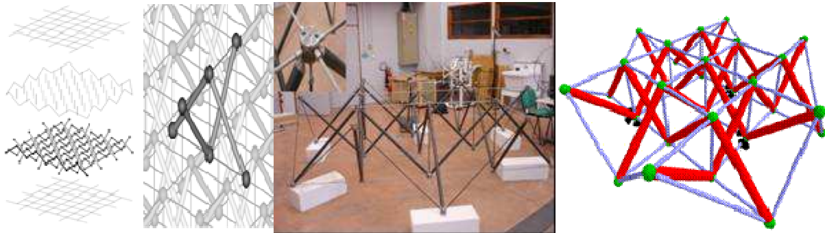
Figure 1 : Principe de conception, la minigrille, sa modélisation.
