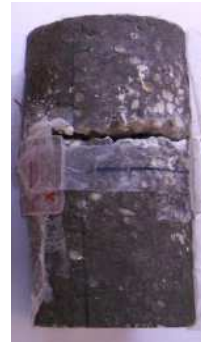
Figure 8. Rupture localisée par bande de compaction obtenue après un essai proportionnel ( k=0,3 )
